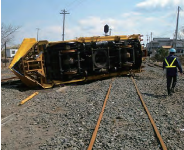
写真 2.2.29 保守用車の転倒（陸中八木駅）
