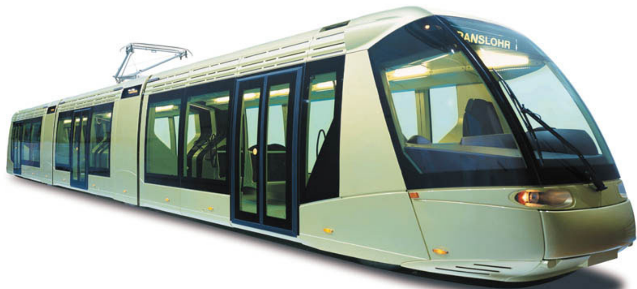
フランス ロール社によって開発されたゴムタイヤ式LRT
