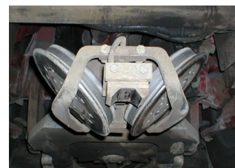
↑: トランスロールの台車構造。走行輪はゴムタイヤです。車軸を挟んで前後に二組の案内装置があり、これが走行路中央の案内レールに沿ってトランスロールの進行を導く役割を果たします。
