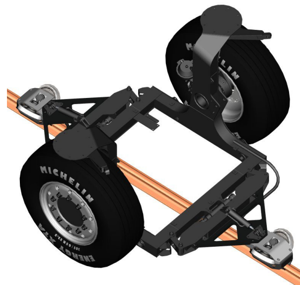
↑: トランスロールの台車構造。走行輪はゴムタイヤです。車軸を挟んで前後に二組の案内装置があり、これが走行路中央の案内レールに沿ってトランスロールの進行を導く役割を果たします。
