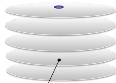
免震積層ゴムの構造
