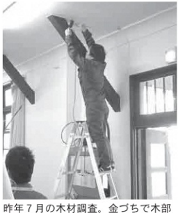
昨年7月の木材調査。金づちで木部に軽い衝撃を与え伝搬速度から強度等を推測
