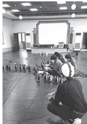
小屋裏で加振中。データ計測中の吉富教授研究室の学生たち
