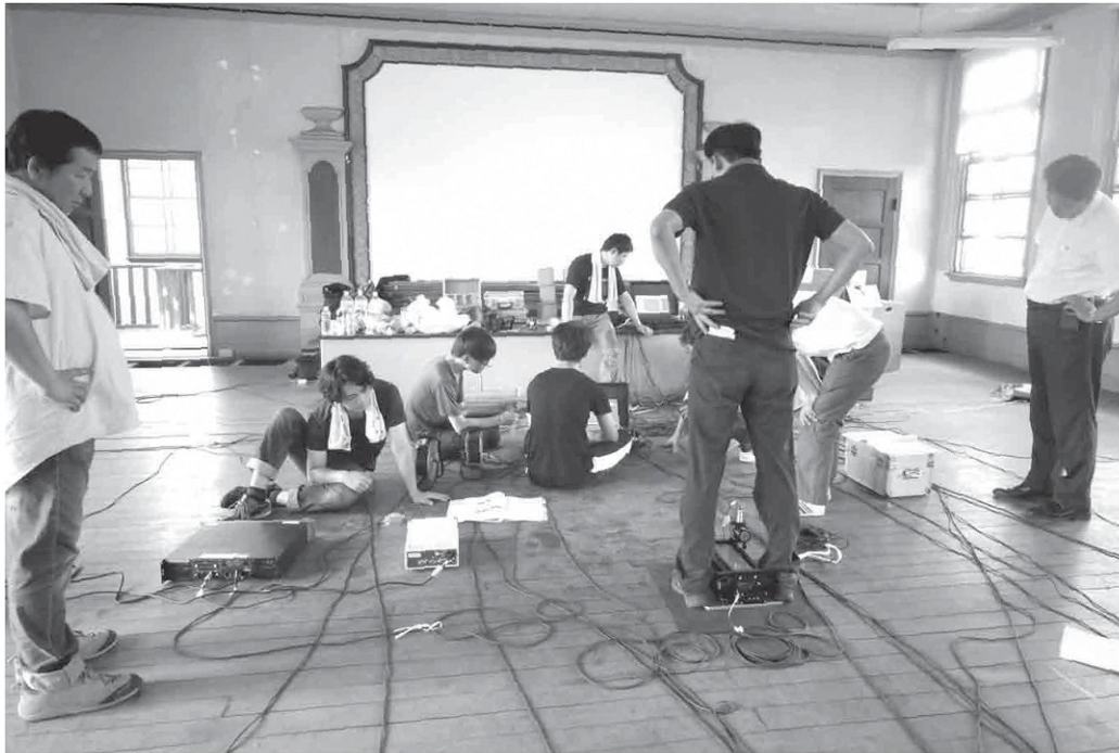
昨年7月の合同調査の様子。地震の振動数の違いによる建物の揺れやすさを調査。40度近い猛暑日が続く中、一日がかりで各種調査を実施しました
