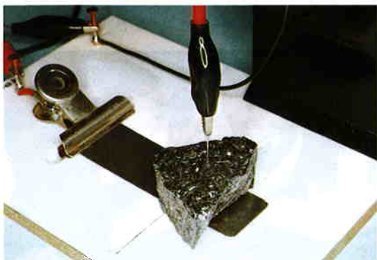
写真2 粗製シリコンを用いた検波装置（針立て式）
