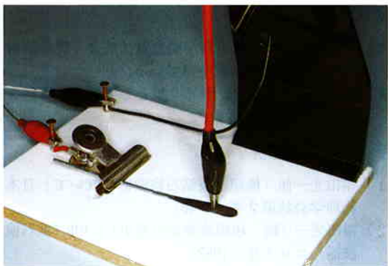
写真3 黒錆びを用いた検波装置（針を使わない）
