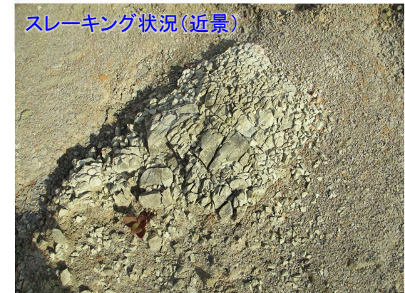
▲降雨による乾湿繰り返しによりスレーキングが発生(土砂化により、細粒分の流出がみられる)
