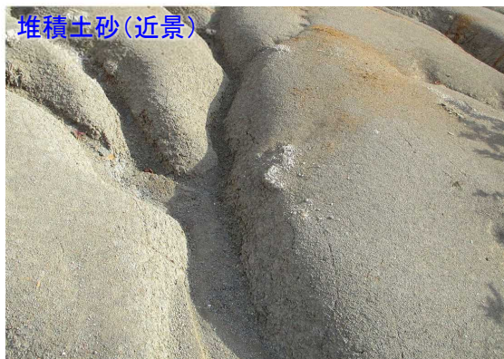
▲降雨による乾湿繰り返しによりスレーキングが発生(土砂化により、細粒分の流出がみられる)
