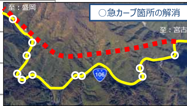
▼ 平津戸地区の急カーブ状況
