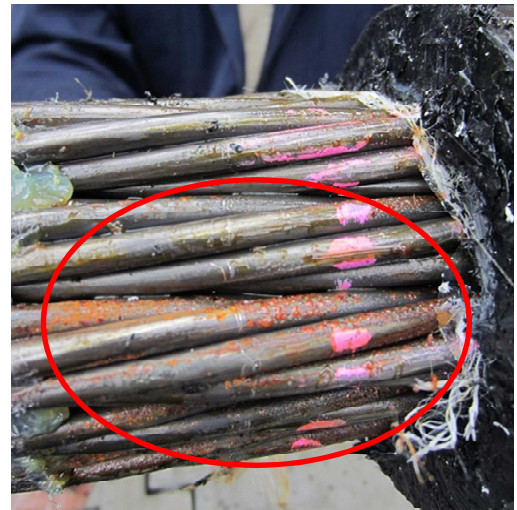
写真-6 PC鋼より線表面の点状の錆
