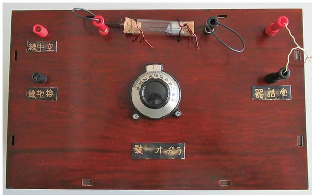
図3 制作したラジオ受信機（正面）
