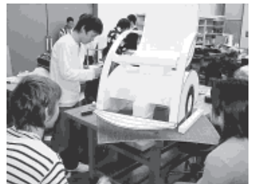
写真 10. 側面パネルとウレタン材をサンドイッチ 立体的に見せる
