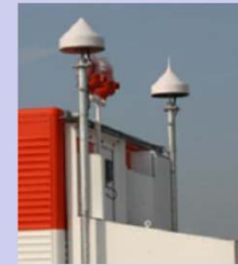
電離圏監視装置
