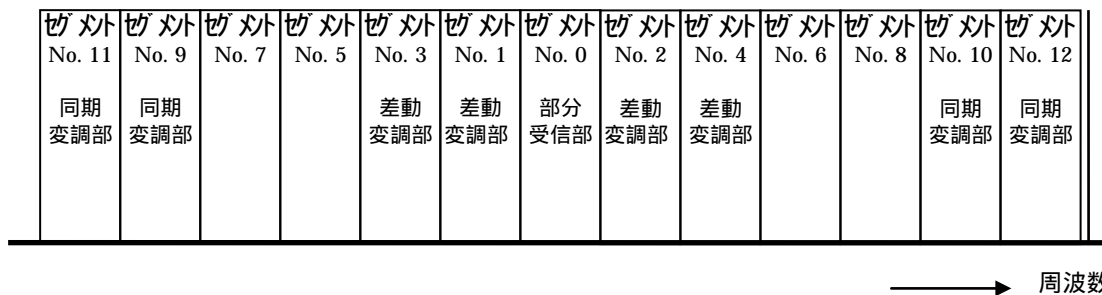
図 3.1.6.14-1 伝送スペクトル上の OFDM セグメント No. と使用例 (13 セグメント形式)
