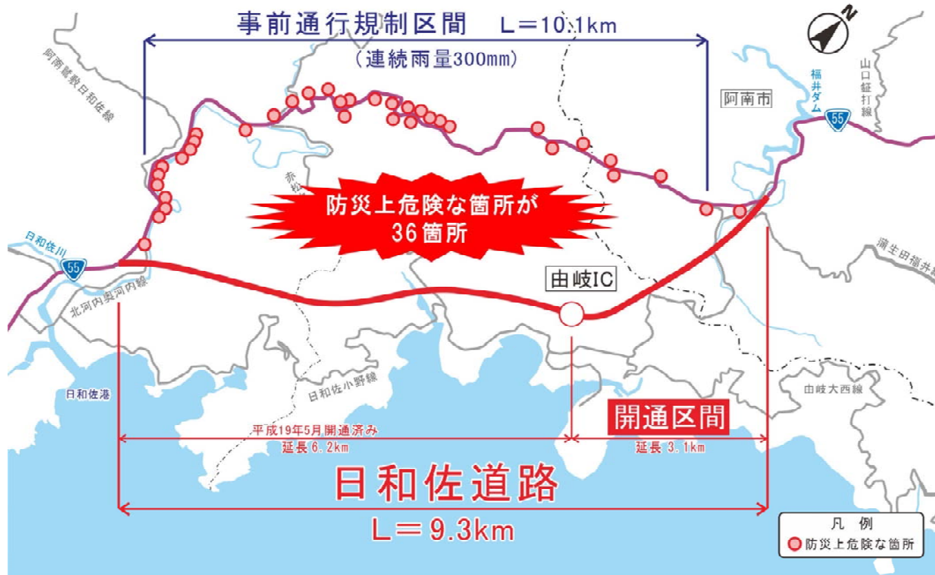
一般国道55号の事前通行規制区間及び防災上危険な箇所 ※防災上危険な箇所は、H22.4月時点
