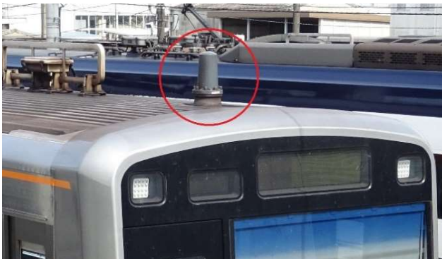
<車上設備 アンテナ>
