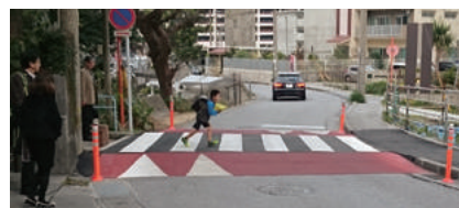
▲久保田教授が開発したハンプ。旧型のかまぼこ型のものに比べると乗り上げ時の騒音、振動が大幅に低減される
