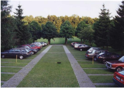
芝ブロックは気温の緩和と地下水の供給のためである (チューリッヒ市、平成2年)
