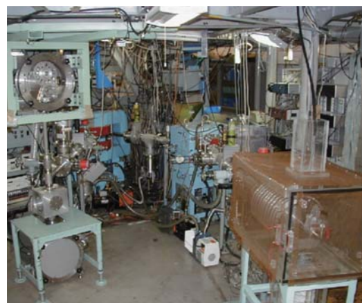
KUR-ISOLの2つのビームコースの写真。 左側にテーブルコネクタを設置した核物理コース、右側に後段加速器を設置した物性コース。
