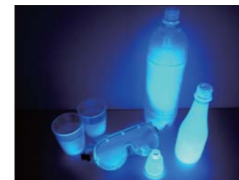
図1 紫外線や放射線によって光るプラスチック。安価で高感度の放射線検出器を開発できる可能性が高い。
