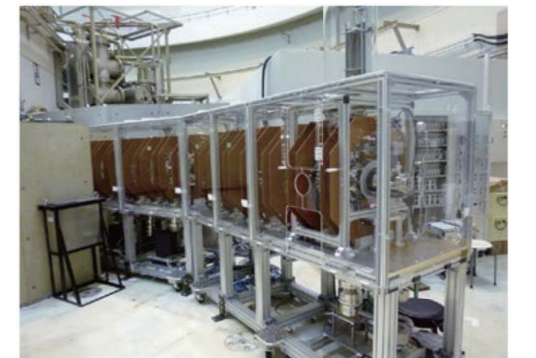
KURのB-1実験孔に設置された原子炉ベース低速陽電子ビームシステム
