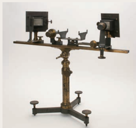
ジャマン干渉計 （土井が反相対論研究に用いた実験機器） 東京大学 駒場博物館所蔵
