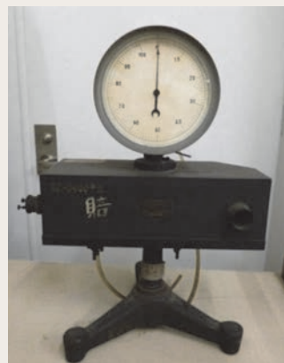
土井式屈折計 （光の干渉を用いて混合ガス、液体、気体等の屈折率を測定） （理研の製品として特許化）
