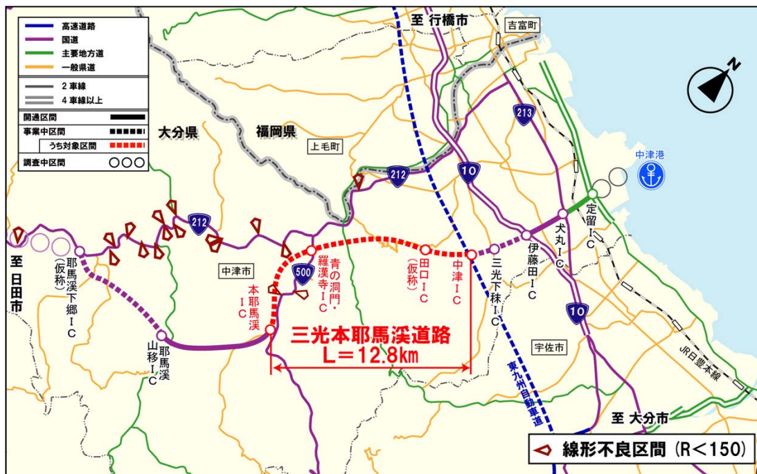
▲並行現道（国道212号・国道500号）の線形不良区間
