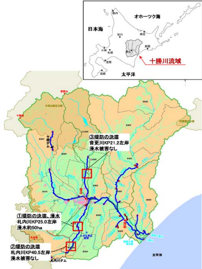
十勝川流域図と堤防決壊箇所(北海道開発局作成資料を一部加工) 11
