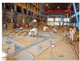
スキッドコンベアー定盤による流れ作業で、効率よく小組立工事ができます。品質も均一化され、短期での製作が可能となっております。また、中組ブロックも移動式作業小屋により安定的な製作ができます。
