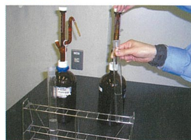
試験管に試料を入れ、色をつけるための薬品を加えます。
