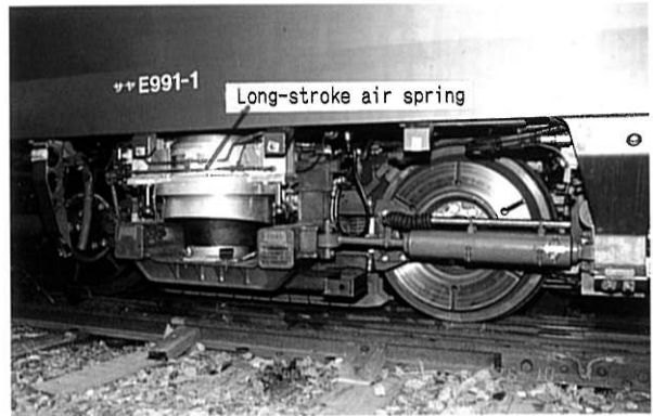
写真1 台車に取り付けたロングストローク空気ばね Photo 1 Long-stroke air spring mounted on a bogie
