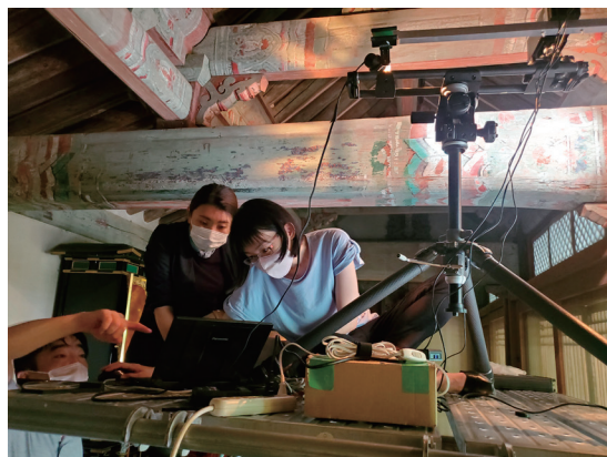
可搬型分析装置を用いた建造物に施されている彩色材料の現地調査(東京文化財研究所)
