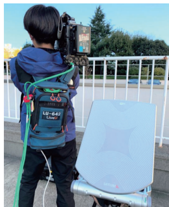
衛星IP伝送装置を使用した中継伝送 携帯電波圏外でも中継・伝送が可能
