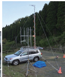
非常用送信車 (熊本地震における電波発射の様子)
