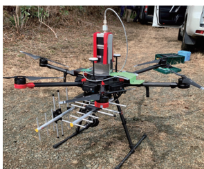
ドローンによる 送信空中線の指向性測定システム
