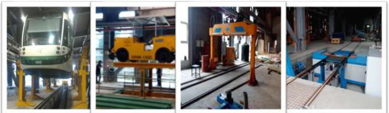
同步抬高機、轉向架維修升降台、轉向架測試壓床、地下式車輪車床
