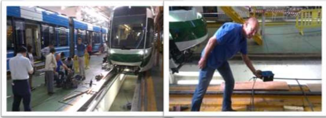
車載號誌系統模擬測試
