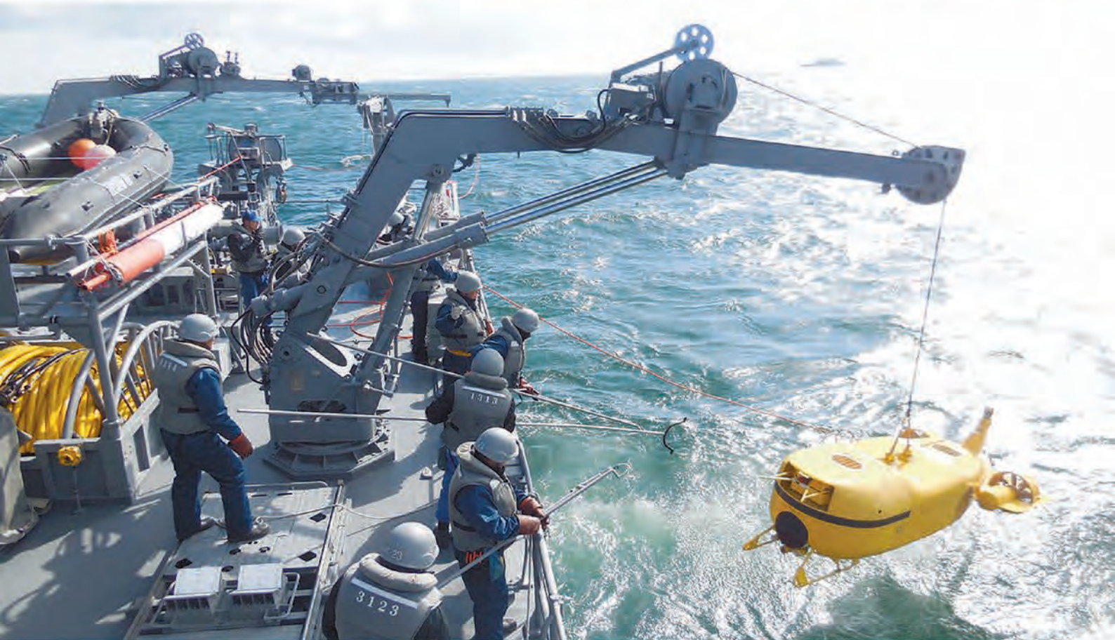
伊勢湾掃海訓練において水中航送式機雷掃討具S-10を揚収する掃海艇「ひらしま」の隊員
