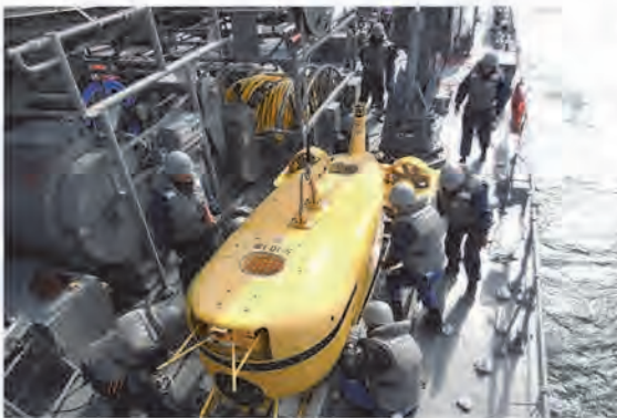
国内開発の最新鋭機雷処分具(水中航走式機雷掃討具S-10)
