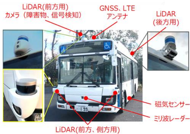
実証実験に用いる中型自動運転バスと装置構成
