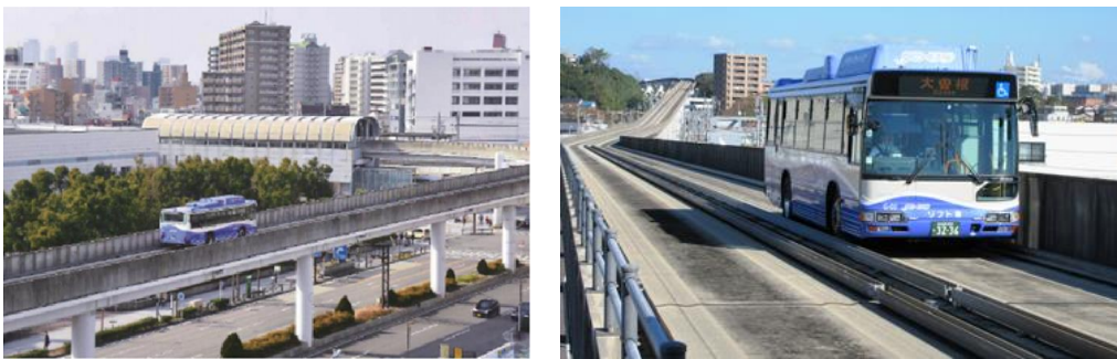
図4-5 ゆとりーとラインのバス専用軌道（ガイドウェイバス） 6
