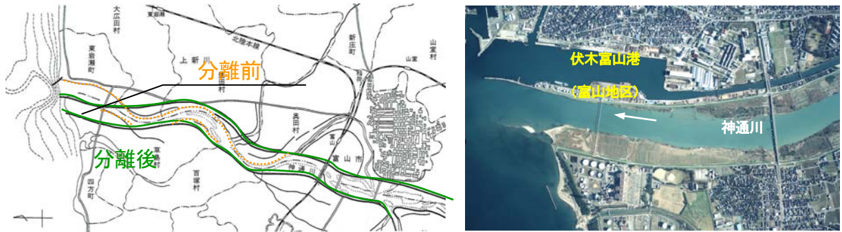
図 4-1 河口河道の付替（東岩瀬港改築工事）
