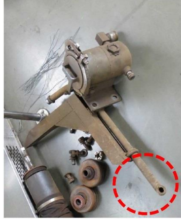
砂撒き装置(セラジェット) ノズル落失 (1両目前台車第2軸) (写真は脱線復旧作業のため、 取り外された状態)
