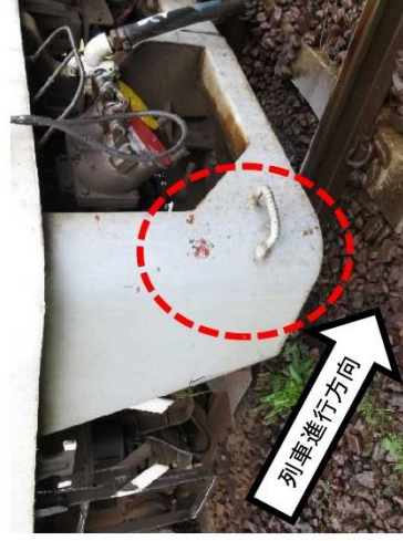
砂撒き装置(セラジェット) ノズル落失 (1両目前台車第2軸) (写真は脱線復旧作業のため、 取り外された状態)
