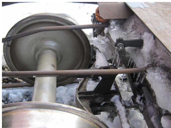
ブレーキばり案内内部に雪を詰めた状態
