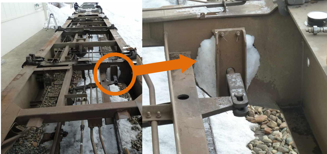
ブレーキダイヤフラムと押棒案内との間に 雪を詰めた状態
