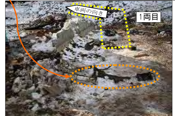
1両目・2両目間の連結器の状況
