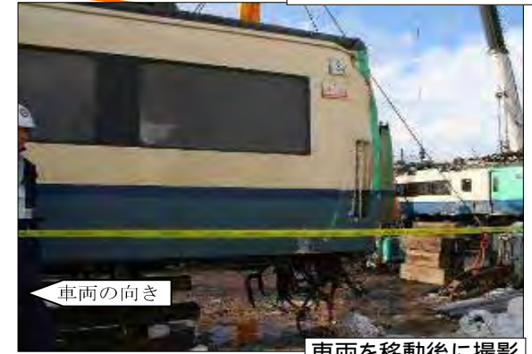
左側面後部の損傷状況
