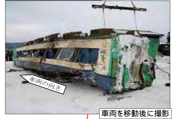
左側面及び後面の損傷状況
