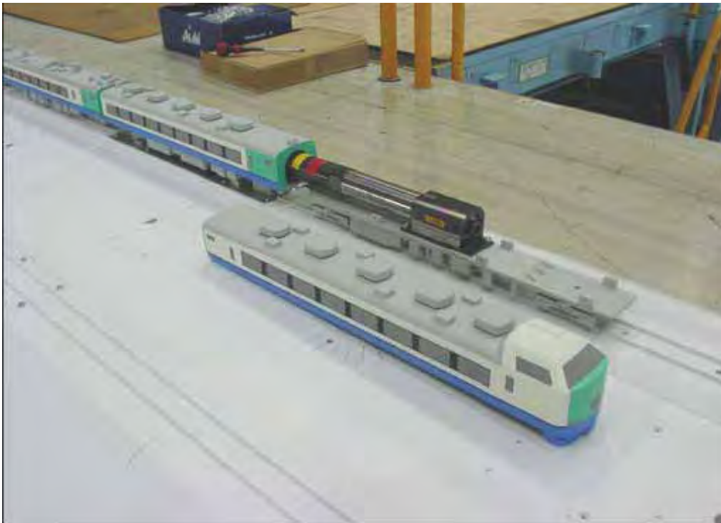
付図 3 8 車両模型及び六分力天秤
