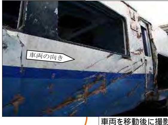
右側面前部の損傷状況
