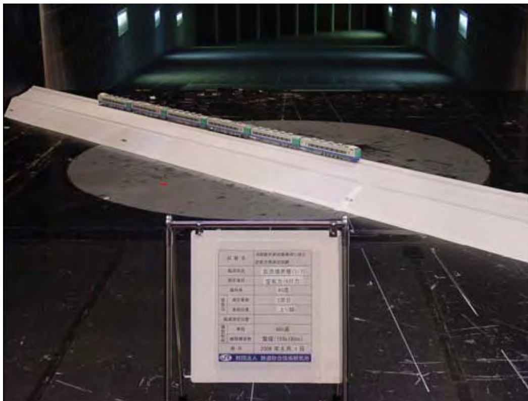
写真 空気力等測定試験の状況
