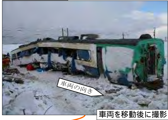
右側面の損傷状況
