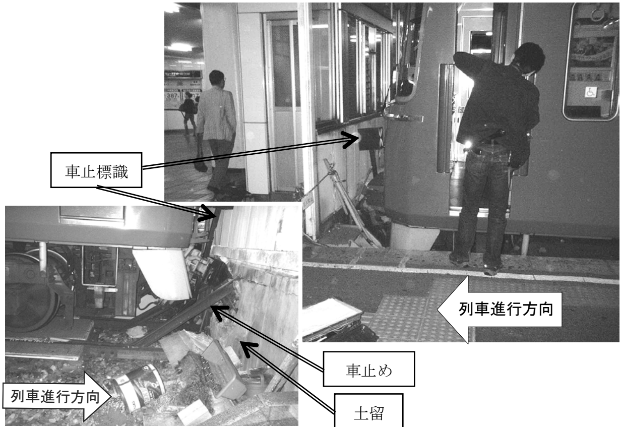
写真1 事故現場の状況（1両目先頭部）
