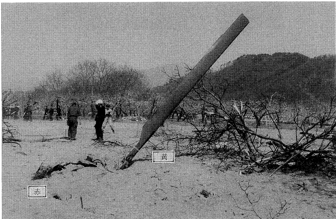
写真2-2 地中に埋没したメイン・トランスミッション及び メイン・ロータ・ブレード (A機)
