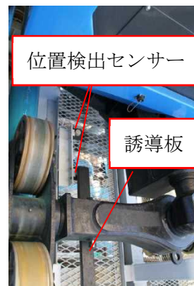
写真6 車両に取り付けられた誘導板
