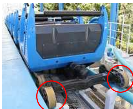
写真4 他号機の車輪破損状況
