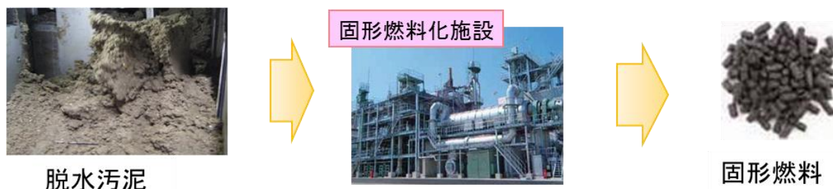
図 3-2-26 下水汚泥の固形燃料化
