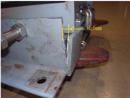
写真13. モーター側ガイドプレート 溶接部破損部
