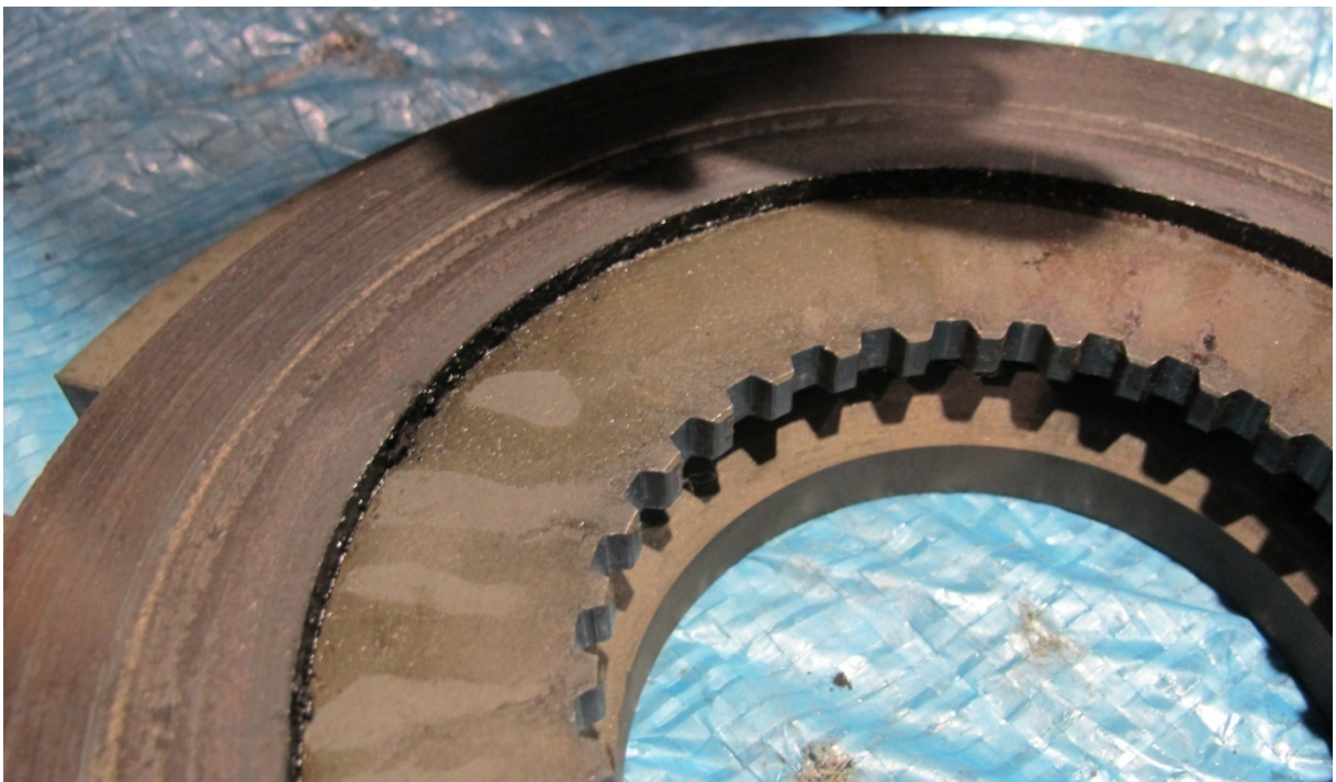
ブレーキディスク内径部分表面に薄い油分の付着が見られる
