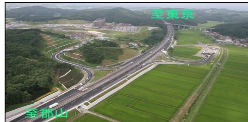
図 本線直結型スマートインターチェンジの例 (白河中央スマートインターチェンジ)
