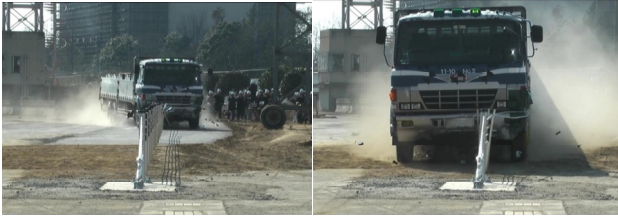
写真-11 防護柵衝突後の大型車の軌跡
