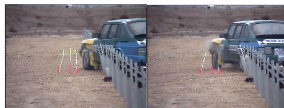
写真-3 ワイヤーロープ式防護柵の衝突実験状況 6)
