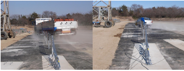
写真-10 車両衝突時の状況 (左: 大型車, 右: 乗用車)
