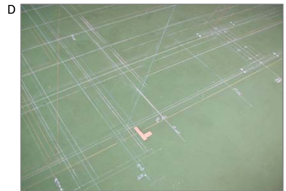
D 鉄鋼所で鋼板にマーキング(けがき)する際に墨つぼや石筆を使います。写真は墨つぼを使用して描いたもの。
