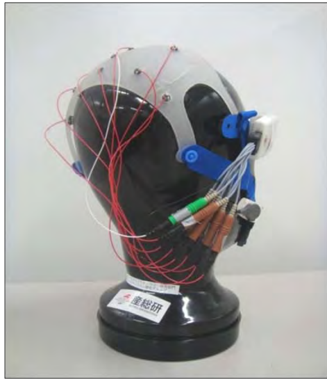
図 2-6 脳波計や電極と組み合わせたヘッドギア完成図
