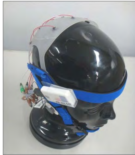
図 2-6 脳波計や電極と組み合わせたヘッドギア完成図
