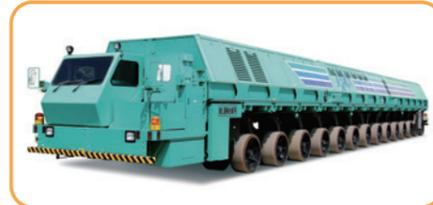
搭載した発電システムで自走するドーリー。積載した衛星にも電気を供給する。
