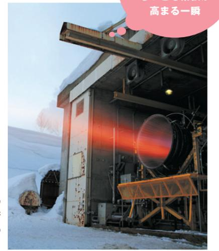
H-IIAおよびH-IIBに用いる第1段エンジンの燃焼試験の様子。1回約50秒の試験では、3,000℃という高温の炎が噴射される。
