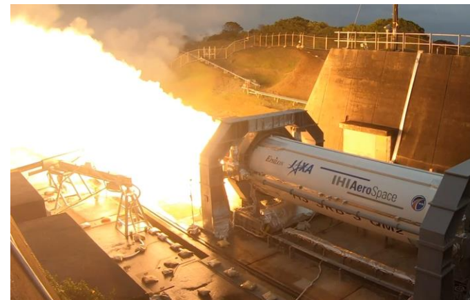
SRB-3実機大地上燃焼試験の状況
