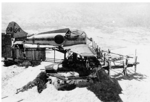
第4図 設置後間もない実験機「九六式艦上戦闘機」(垂直尾翼の記号から航空母艦名が分る。良く見ると補助翼が付いていない)。(写真提供:中谷宇吉郎雪の科学館, 菊地ほか、2006)。
