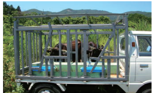
図8 車載式連動スタンション (農研機構畜産草地研究所)
