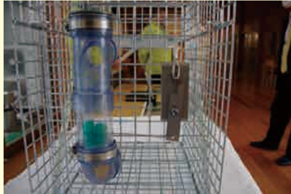
筒を貫通したワイヤーが扉をロックしている金具と連結している。ワイヤーを引くと金具がはずれ扉がしまる。
