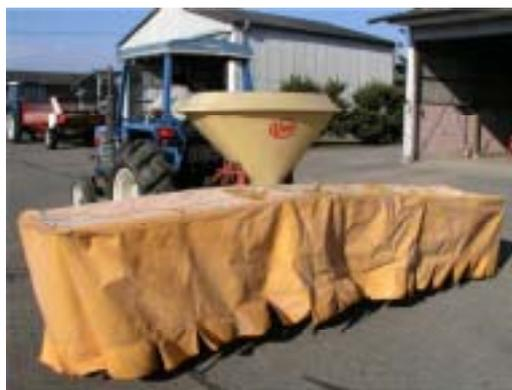
ブロードキャストは、主に粒状の土壌改良資材、化成肥料の施用に使用する機械であるが、牧草や麦類など中粒種子の全面散布（全面播種）機械としても使用されている。作業能率が高く利用範囲も広いので、機械化利用組合などに導入されている。
