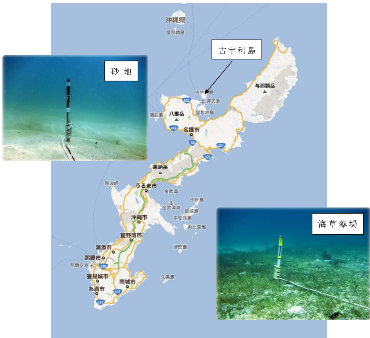
図3 沖縄におけるジュゴンが航空機などによって確認されている沖縄本島西海岸の古宇利島に、ステレオ式自動水中音録音システム（ジュゴン用）（AUSOMS-D）を2台設置した。1台はジュゴンによる摂餌痕が確認された海草藻場内（右下）、もう1台は底質が砂地（左上）に設置
