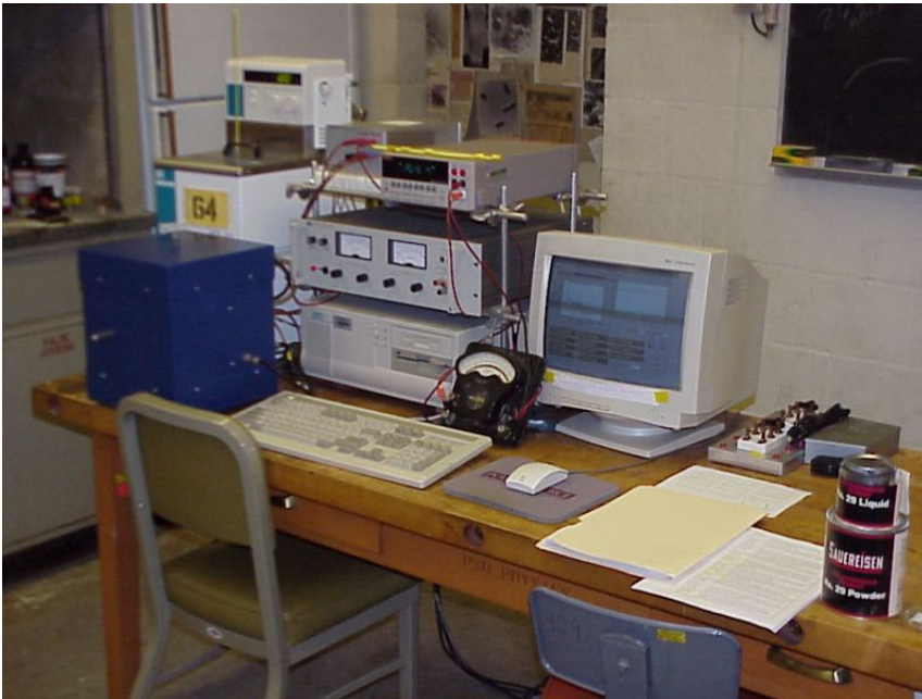
図 1.9. 典型的な常温核融合の実験。ゼーベック熱量計（左にある箱）で行う。ジョン・ダッシュ、ポートランド州立大学の研究室。写真撮影は D.チキア。B.ジマーマン提供。熱量計は 6,000 ドルかかる。他の備品を含めて大体の実験は約 50,000 ドルかかる。ボランティアの学生や引退した教授が実験を行うから人件費はかからない。優れた実験は一回につき 50 から 300 メガジュールを発生したことがある。熱核融合が 60 年努めても達成できなかった主要目的を見事に成功した。
