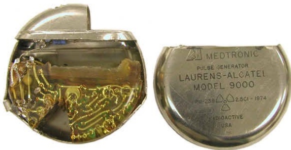
図 2.2. プルトニウムの熱電池によって作動する心臓ペースメーカー。プルトニウム材料は上の穴に入っていたが摘出されている。この類の装置は数百人の患者に埋め込めたが悪影響はなかった。常温核融合も規模を縮小できるし好きなだけ拡大することもできる。写真提供 http://www.orau.org/ptp/collection/Miscellaneous/pacemaker.htm
