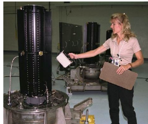
図 2.1. NASA のカッシーニ宇宙探査機無人調査船の多目的熱源の放射性同位元素熱電発電機 (General Purpose Heat Source Radioisotope Thermoelectric Generator - GPHS-RTG) (熱電池)。
