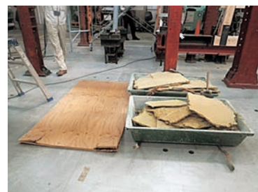
図18 実験後の耐震補強建具と土壁
